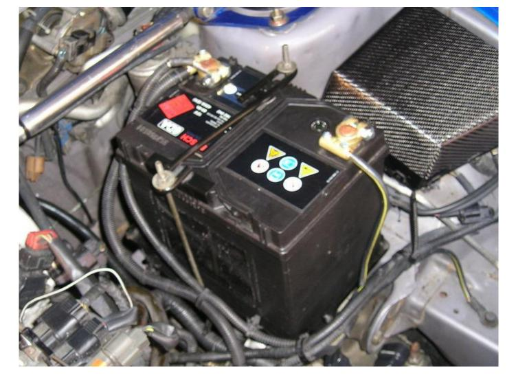
TIDY UP THE CABLES AND MAKE SURE THEY ARE NOT BEING PULLED ANYWHERE LEAVING 'SLACK' AT THE TERMINAL ENDS.
